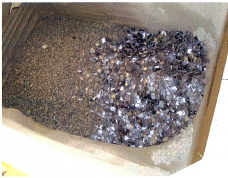
拌合槽添加鋼纖維
