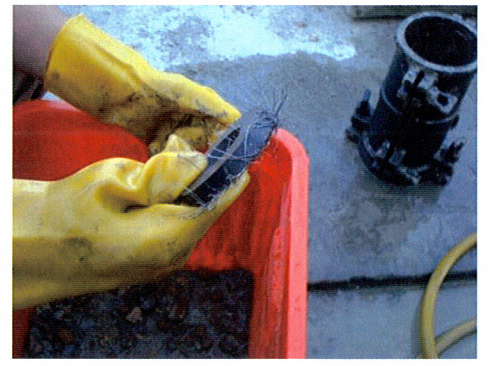
鋼纖維含量的現場施作
